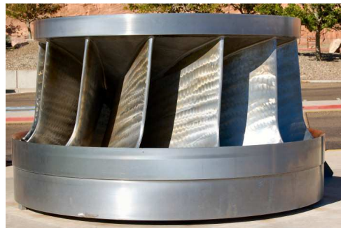
Turbina Francis. Imagen de RJHall en Wikipedia bajo licencia CC
