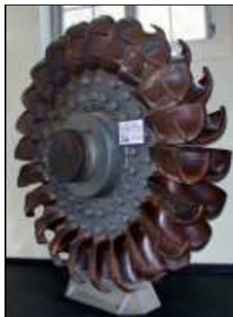
Turbina Pelton. Imagen de Softeis en Wikipedia bajo licencia CC
